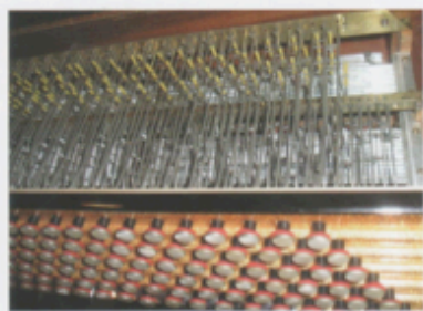
Sur le clavier gauche, le système de tringlerie qui permet à une touche de produire un accord (trois notes) est un chef-d'œuvre de technologie... (Photo Thibaut Amant)
